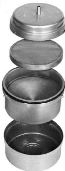
شکل ۱- سل آزمون تراوش تحت فشار A
